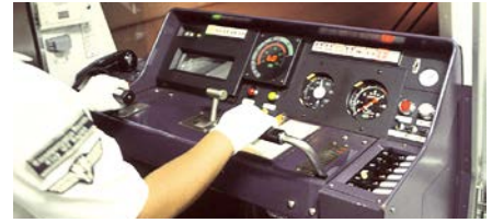
ATC (自動列車制御装置)
